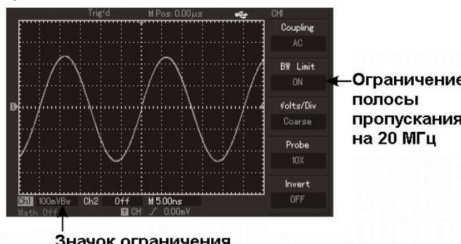
Рисунок 2-5. Вид дисплея при ограничении полосы пропускания
