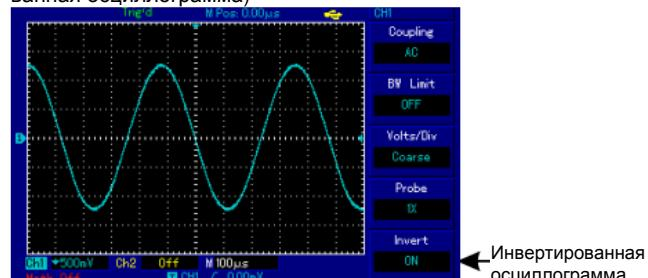
Рисунок 2-9. Настройка вертикальной инверсии (инвертированная осциллографма)
