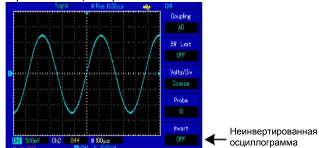
Рисунок 2-8. Настройка вертикальной инверсии (не инвертированная осциллографма)
