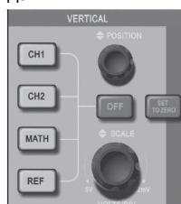
Рисунок 3-13. Зона управления вертикальной разверткой в осциллографах с 5,7-дюймовым дисплеем
