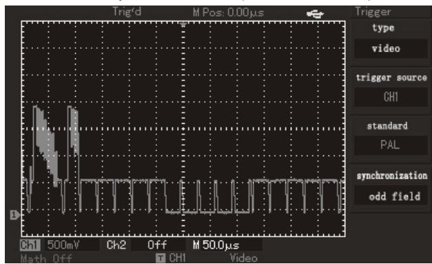
Рисунок 3-8. Запуск по синхроимпульсу кадра видеосигнала
