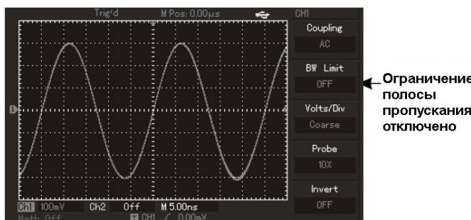
Рисунок 2-4. Вид дисплея без ограничения полной полосы пропускания.
