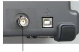
Выход сигнала функции PASS/FAIL на задней панели осциллографа
