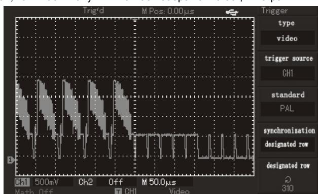
Рисунок 3-9. Запуск по синхроимпульсу строки видеосигнала
