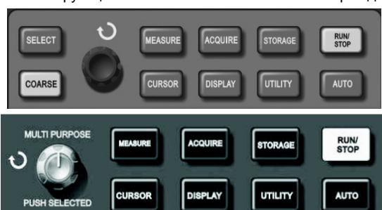
Рисунок 2-19. Функциональная кнопка системы выборки данных.
