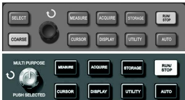
Рисунок 2-30. Функциональная кнопка курсорных измерений (CURSOR) в системе выборки данных
