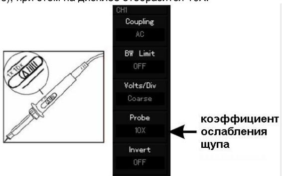
Рисунок 1-6. Установка коэффициента ослабления в настройках осциллографа
