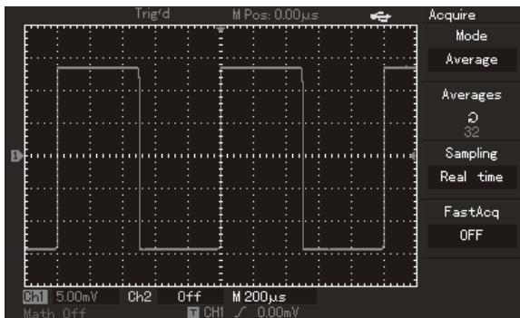
Рисунок 3-5. Сигнал с подавленным шумом
