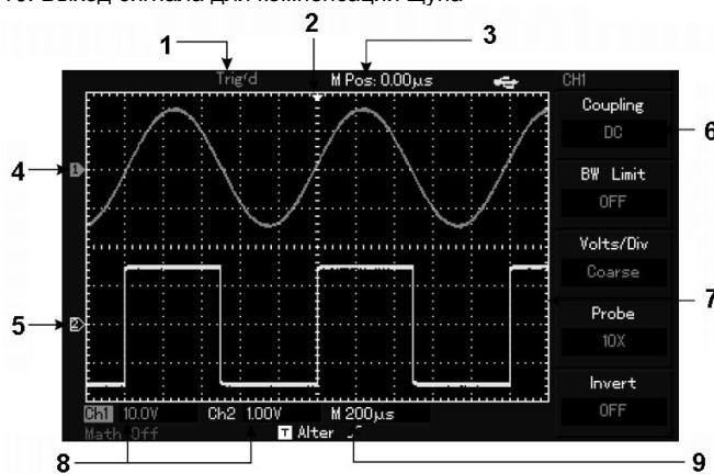
Рисунок 1-3. Схема интерфейса дисплея
