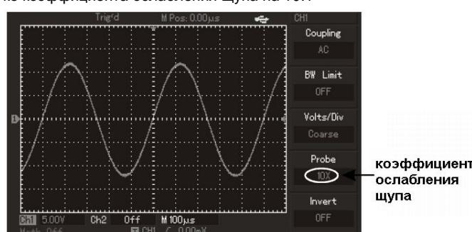
Рисунок 2-6. Установка коэффициента ослабления щупа в меню канала.
