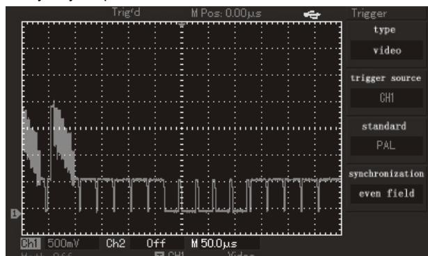
Рисунок 2-16. Запуск по синхроимпульсу кадра видеосигнала
