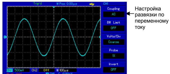
Рисунок 2-1. Отсечение постоянной составляющей сигнала
