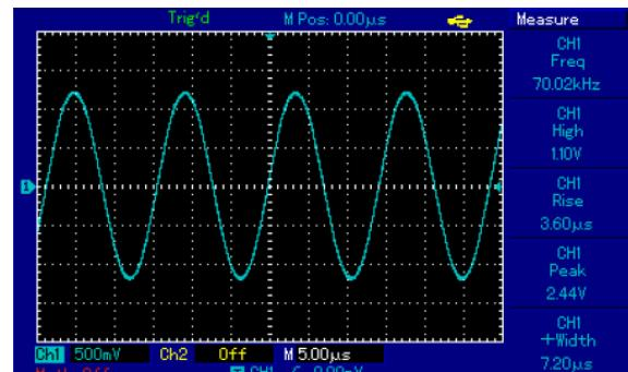
Рисунок 3-1. Автоматические измерения
