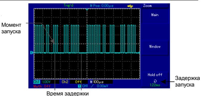
Рисунок 2-18. Использование функции задержки для синхронизации сложной осциллограммы
