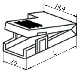
Применяется контакт флажкового типа. Ф57.732.091
