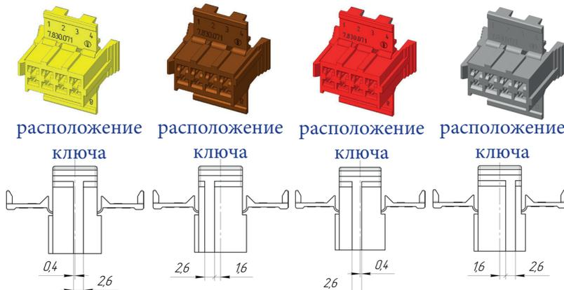
Габаритные, установочные и присоединительные размеры, мм.
