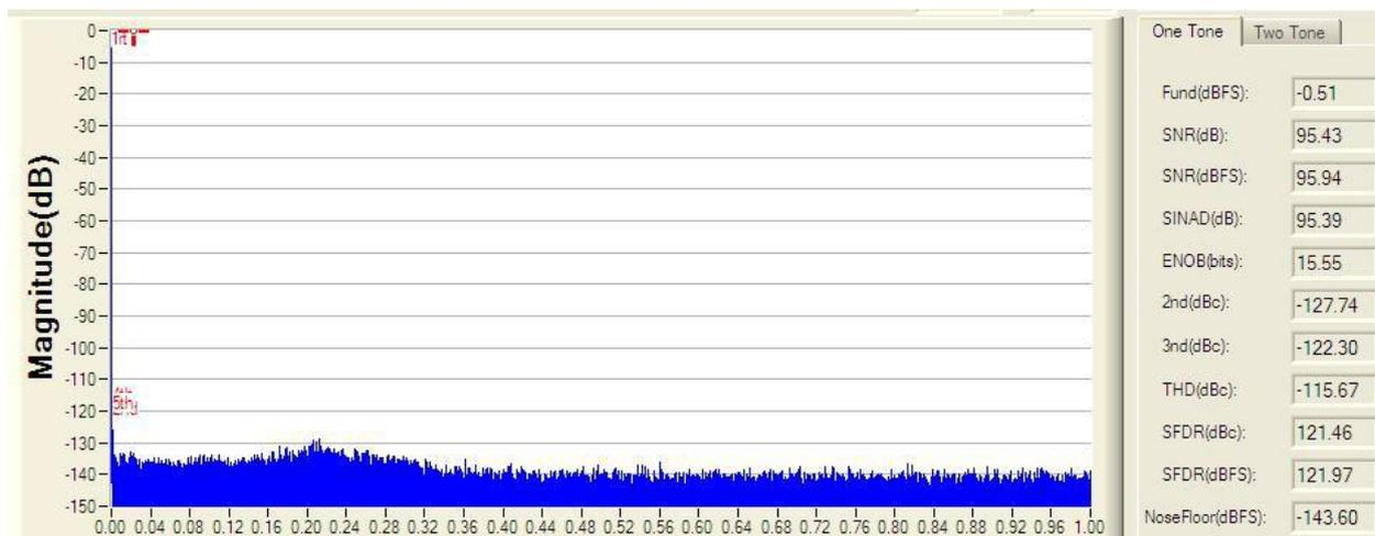
18 位 A/D 转换器随输入信号频率动态性能变化曲线
