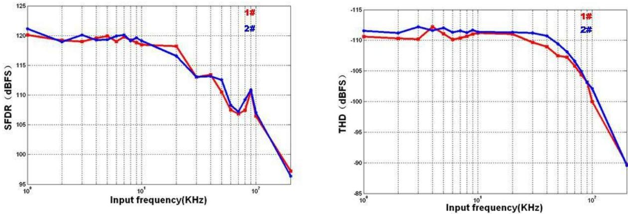
图 7 18 位 A/D 转换器 SFDR/SNR 指标随输入信号频率变化曲线
