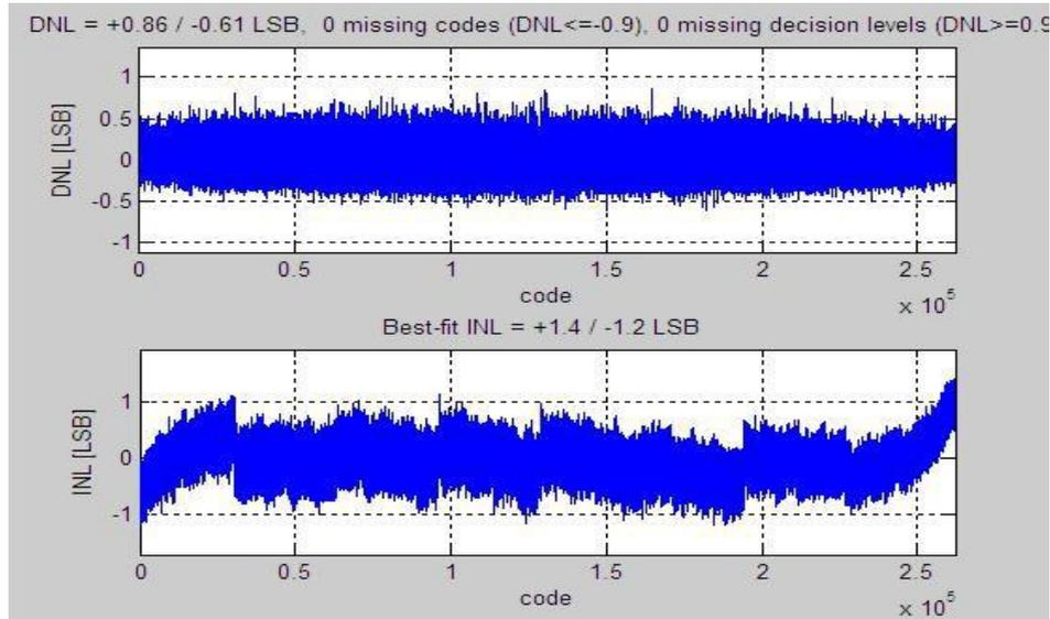
图 5 18 位 A/D 转换器静态特性曲线图
