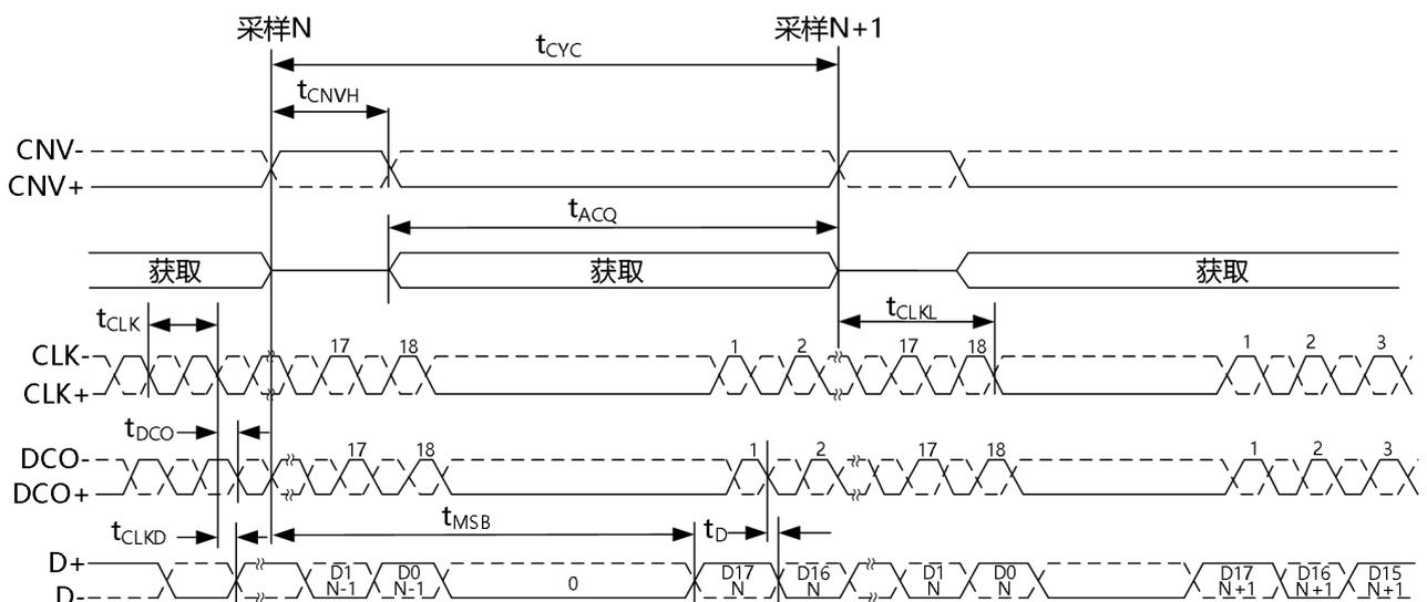
图 2 转换启动和数据输出时序图
