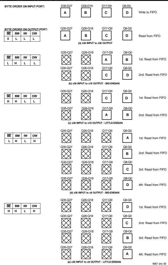
Figure 4. Bus-Matching Byte Arrangement
