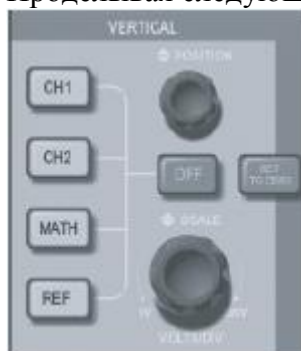
Рис. 1-9 Зона вертикального контроля на передней панели
