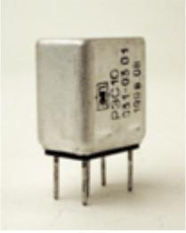
Электромагнитное слаботочное защищённое реле постоянного тока с переключающим и замыкающим контактами предназначено для коммутации цепей постоянного тока. Реле РЭС 10 выпускается по техническим условиям РС 0.452.049 ТУ
