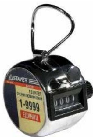
Предназначен для отсчета предметов или действий при различных видах работ, который производится при нажатии до упора на кнопку (однократное нажатие увеличивает показания счетчика на одну единицу). Показания легко считываются благодаря увеличенным цифрам. Установка счетчика на «0» производится вращением регулятора сброса по часовой стрелке. Диапазон измерений: 1-9999.
