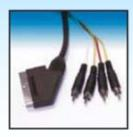
Кабель межблочный SCART вилка на 4RCA вилка. Воспроизведение и запись: видеоканал моно аудио-канал или стерео аудио-канал. Общий экран. Пластиковые неразборные наконечники. Медный многожильный проводник в ПВХ изоляторе. Предназначен для соединений в аудио-видеосистемах.
