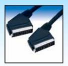
Кабель межблочный SCART вилка на SCART вилка. Пластиковые неразборные наконечники. Полная распайка, медный многожильный проводник, общий экран, ПВХ изолятор. Предназначен для соединений в аудио-видеосистемах. **BW1105 (1.5м, пакет)**
