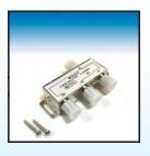
Высокочастотный (5-1000 МГц) разветвитель (сплиттер) на 3 направления. Входы и выходы под F-разъем. Металлический неразборный корпус. Используется для разветвления ТВ-кабелей. Поставляется в комплекте с шурупами для крепления к стене. **BW1603 (пакет)**
