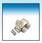
Высокочастотный (5-1000 МГц) разветвитель (сплиттер) на 2 направления. Входы и выходы под F-разъем. Металлический неразборный корпус. Используется для разветвления ТВ-кабелей. Поставляется в комплекте с шурупами для крепления к стене. **BW1602 (пакет)**
