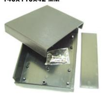
Корпус изготовлен из черного пластика, толщина стенок 3,5 мм. Соединение нижней и верхней части осуществляется 2-мя саморезами 2,5х30 мм (прилагаются).
